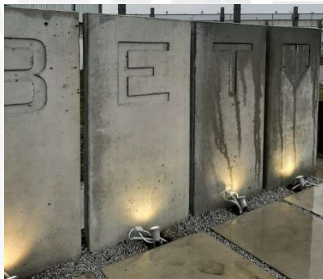
Rys. 5. Po lewej mury zaimpregnowane impregnatem LOVBET, po prawej bez impregnacji.
