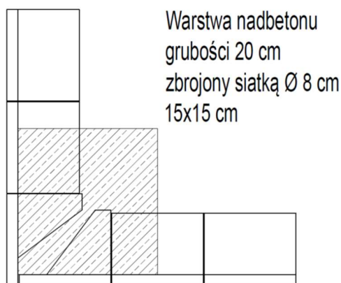
Rys.8.Schemat wykonania narożnika z warstwą nadbetonu.
